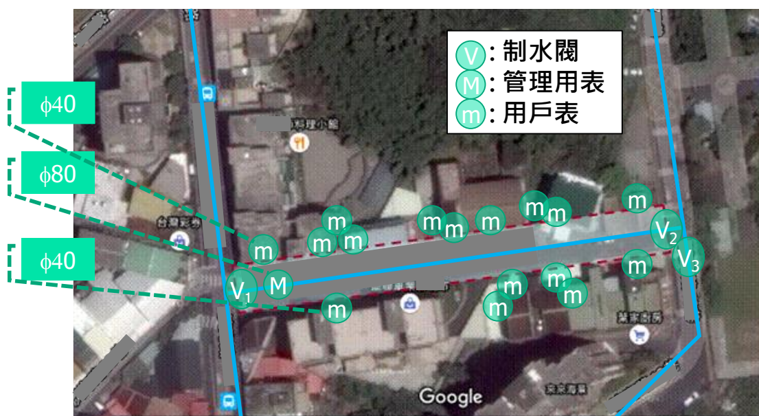
圖1、標的供水管網計量分區 (DMA) (簡稱DH小區) 及水量監測物聯網 (IoT) 配置圖
