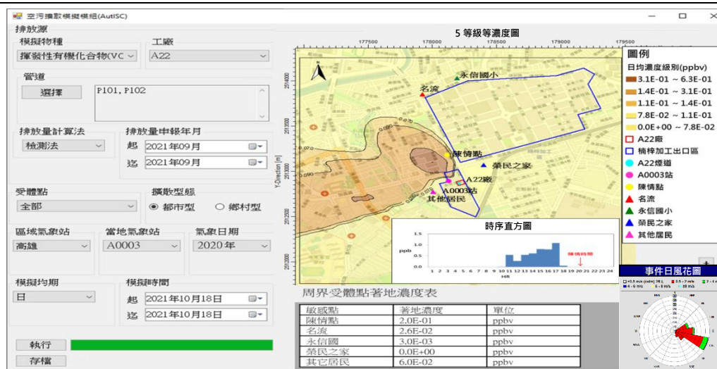
圖 3. ISC 模組操作介面及 A 事件日 5 等級擴散模擬等濃度圖
